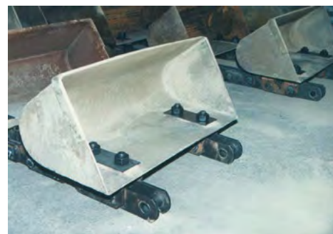
Catena smontabile con perni con testa Detachable chain with head pins Cadena desmontable con ejes con cabeza
