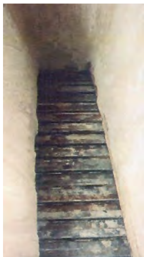
Trasportatore speciale a placche rinforzato Special conveyor with reinforced plates Transportador especial de placas reforzado
